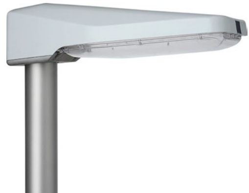
FILOS Baureihe 42...VARIO 17-35W / 2.830-5.350lm / 4000K Ersatz für: 80W HQL bei 19W / 125W HQL bei 22W / 70W NAV bei 32W / 2x80W HQL bei 41W
