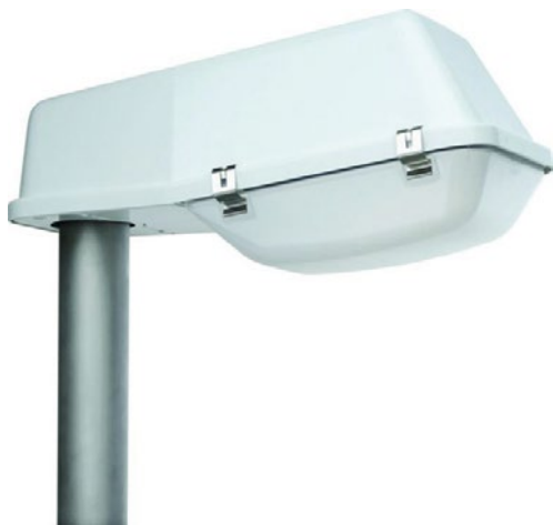
LED-Kofferleuchte Baureihe 43L... 25W / 3950lm / 4000K Ersatz für ca. 125W HQL
