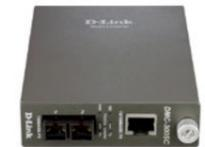
Ethernet Standards: 10/100BaseTX, RJ45 Port: 10/100Mbps, Full/Half-Duplex, Funktionen: Auto-Negotiation, Auto MDI/MDIX, kompatibel zu Flow Control, LWL Port: SC Duplex, 100 Mbps, Wellenlänge-Licht: 1300 nm, Glasfaser Übertragungsweg: bis 2000 m, Diagnose LEDs, Dip-Switch für Übertragungsarten, Montageart: Einzelaufstellung, Chassis (Hot-Swap), Metallgehäuse, Tiefe: 120 mm, Höhe: 88 mm, Breite: 25 mm, Betriebsspannung: 7,5 V<sub>i</sub> (externes Netzteil).
